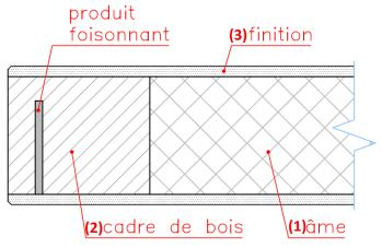
(1) L'âme est un panneau de particules plein à base de fibres de lin et de copeaux de bois ayant une densité de 400kg/m³.
