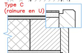
La couche de plomb ne court pas dans le couvre chant et n'est pas visible sur le chant de porte.
