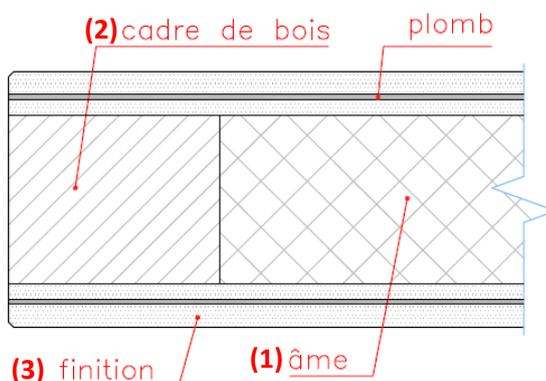
**(1)** L'âme est un panneau de particules plein à base de fibres de lin et de copeaux de bois ayant une densité de 400kg/m<sup>3</sup>.
