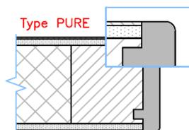
Le vantail sera préalablement dégraissé avant le moulage du couvre-chants avec un angle de 3° de sorte que le couvre-chant aura la même épaisseur de part et d'autre du vantail.
